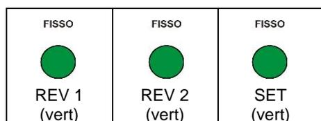
Pour confirmer, appuyer une brève impulsion avec la touche PS2. : Les 3 LEDS s'allument fixe vert pour 2 secondes en indiquant la mémorisation du temps de travail.
